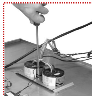
3° Recoloque os dois termômetros (observe o posicionamento correto), a trava dos termômetros e o parafuso de fixação da trava.
