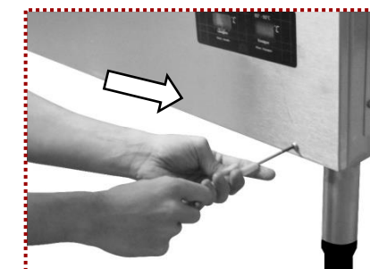
6° Rosqueie os parafusos de fixação do painel frontal; do painel lateral direito e do painel traseiro, utilizando uma chave allen (4mm) (APERTAR SUAVEMENTE).
