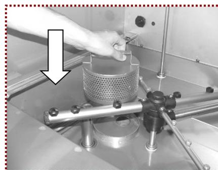
1- Verifique se o filtro da moto bomba está devidamente encaixado no anel do tanque; e pressione-o para baixo até encostar no fundo do tanque da lavadora.
