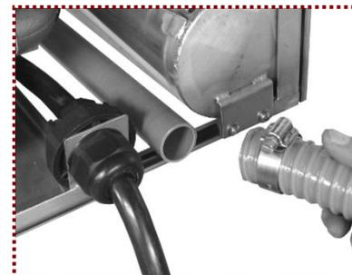
Montar a mangueira espiralada no tubo de saída de esgoto da lavadora, apertar a abraçadeira da mangueira utilizando uma chave de fenda.
