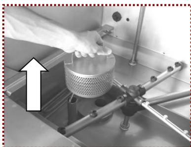
5- Aguarde a drenagem da solução do tanque, retire o filtro da moto-bomba, lave-o em água corrente.
