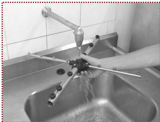
11- Montar os tampões nas extremidades dos braços de lavagem, encaixar os braços giratórios nos seus respectivos eixos, montar os parafusos sede e os tampões. Girar manualmente os braços nos dois sentidos e verificar se giram livremente; caso não girem livremente, retirar o braço giratório, limpar o eixo e o interior da bucha central do corpo, com água corrente ou pano umedecido.
