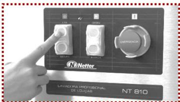
1° Desligue a lavadora, conforme item “Desligando a Lavadora” anterior.
