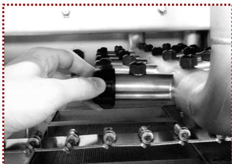
4° Desrosquear e remover os tampões das extremidades do braço da lavadora, conforme figura ao lado.
