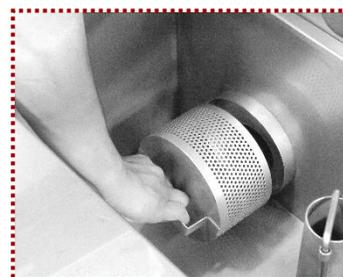
5° Aguarde a drenagem da solução do tanque, retire o filtro da moto-bomba, lave-o em água corrente.
