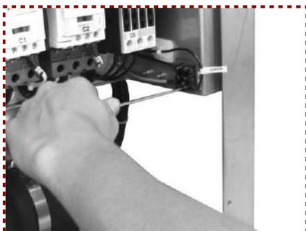
3° Com uma chave de fenda pequena, faça a modificação no borne localizado na lateral do comando, conectando o cabo preto (comum) com o cabo azul quando a tensão da rede local for 380 V 3N ~ 60 Hz, ou com o cabo preto quando a tensão da rede local for 220V 3~ 60 Hz.
