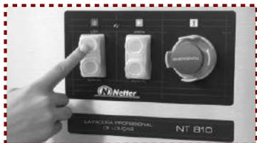
1° Desligue a lavadora, conforme item “Desligando a Lavadora” anterior.
