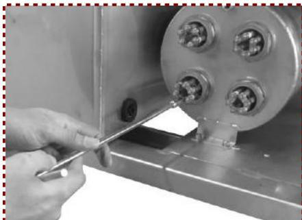
1° Com uma chave canhão ( 8mm) remova as porcas dos filamentos das resistências de enxágue e lavagem e faça o fechamento correspondente a tensão da rede ( estrela ou triângulo).
