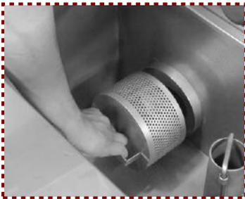
1° Verifique se o filtro da moto bomba está devidamente encaixado no anel do tanque; e pressione-o até encostar na lateral do tanque da lavadora.
