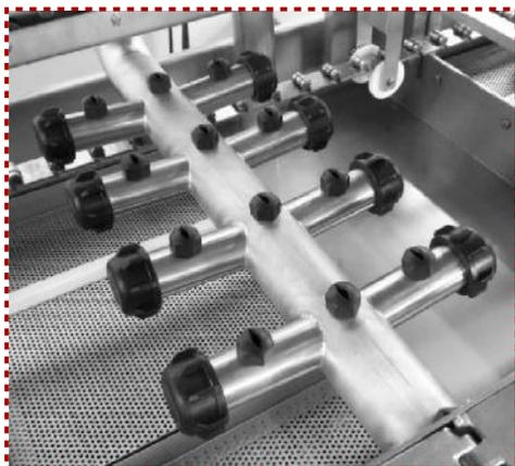
5° Lavar os bicos e o interior dos tubos com água corrente, verificar se saíram todos os resíduos dos bicos e do interior dos tubos, se necessário limpar o furo dos bicos com arame de cobre, haste plástica ou haste de madeira, e lavar novamente em água corrente.
