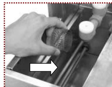
10° Verifique se o filtro da moto bomba está devidamente encaixado no anel do tanque; pressione-o para o lado até encostar na lateral do tanque da lavadora.
