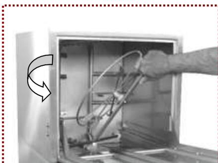
5° Retire a base giratória, levantando a parte dianteira da travessa frontal e girando-a até os rodízios desencaixarem dos trilhos.
