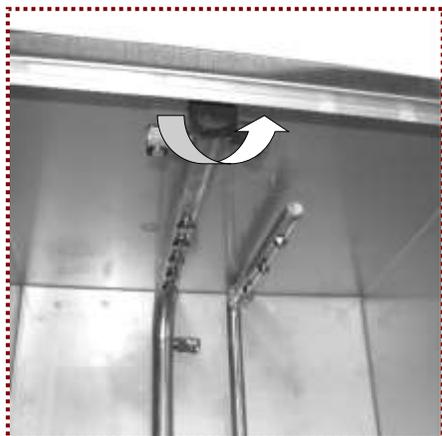
9° Desrosquear e remover o tampão de plástico na extremidade frontal do braço de lavagem superior.
