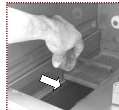
8° Verifique se o filtro da moto bomba está devidamente encaixado no conector da moto-bomba; e pressione-o para a direita até encostar na parede do tanque da lavadora.
